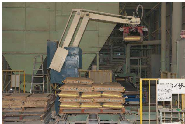
ロボットによる珪藻土製品の積みつけ
