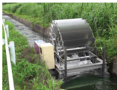
小水力発電装置実証試験
